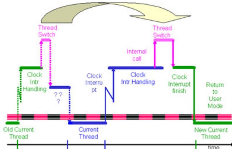
Wiederum wird der Trick angewendet, dass man innerhalb der `thread_switch` Prozedur nur den Stack austauscht, um so vom rechnenden Thread zum neuen Thread umzuschalten. Dies geht allerdings nur dann, wenn es sich bei `thread_switch` um eine Prozedur handelt und nicht um ein Makro, wie dies beispielsweise im L4-Mikrokern gemacht wird.
