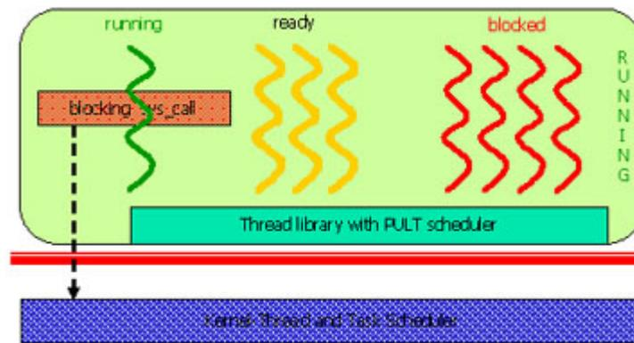
Da die Threadbibliothek nicht zuständig ist für die Bearbeitung des Systemaufrufs, wird der Kern eingeschaltet. Der Kern wiederum blockiert nun die ganze Task, wobei aus der "eingeschränkten" Sicht des PULT-Schedulers der User-Level Threadzustand des PULT nach wie vor rechnend ist, denn dieser PULT-Scheduler ist ja überhaupt nicht in die Bearbeitung des Systemaufrufs involviert. Somit ergibt sich folgender Systemzwischenzustand:
