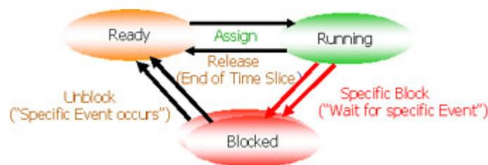
Das obige Threadzustandsdiagramm ist geradezu klassisch und in dieser oder ähnlicher Form in den meisten Betriebssystemen auch realisiert. In dynamischen Systemen muss man auch Zustände einführen, die einen neuen Thread bzw. einen gerade beendeten Thread aufnehmen, manchmal ist es auch nützlich, Threadzustände einzuführen, mit denen man ausdrücken kann, dass ein Thread oder die gesamte Task aktuell im Hintergrundspeicher (z.B. auf Platte) im so genannten *swap device* ausgelagert ist.
